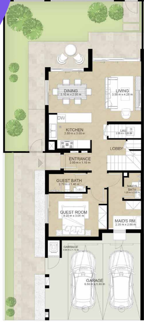
GROUND LEVEL الطابق الأرضي
